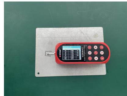
铁片表面粗糙度——测试实例
