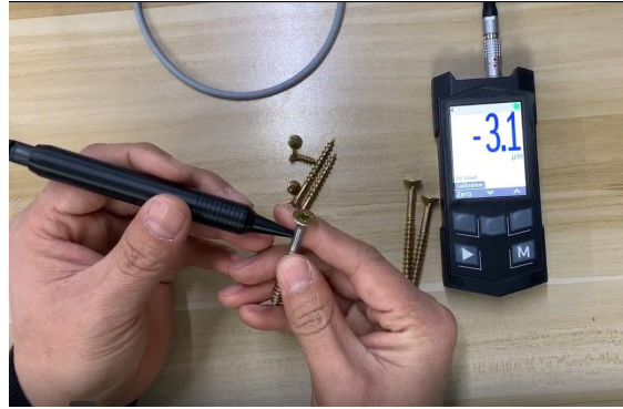
自攻钉镍层厚度检测——K6-C+PH3
