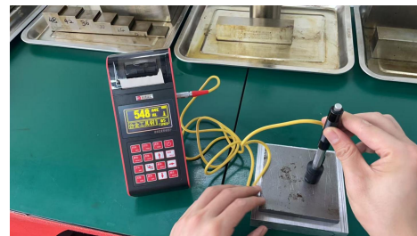
钢板硬度——测试实例
