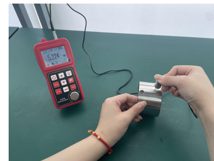
钢管厚度——测试实例
