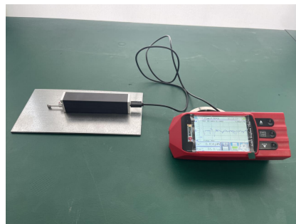
铁片表面粗糙度——测试实例
