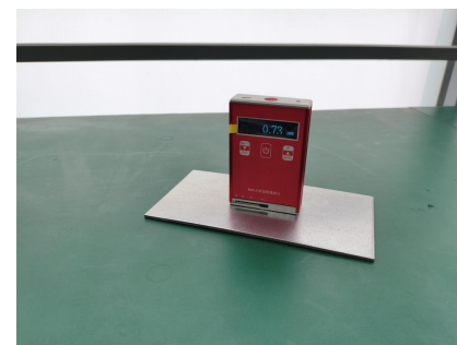
铁片表面粗糙度——测试实例
