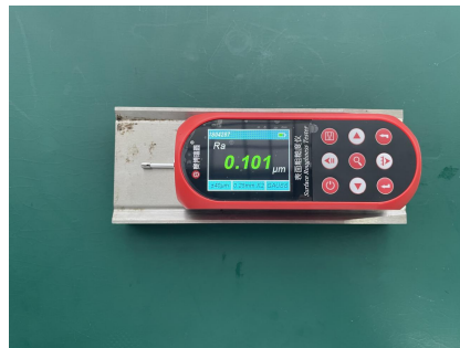
钢板表面粗糙度——测试实例
