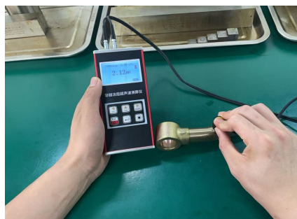
铜管厚度——测试实例
