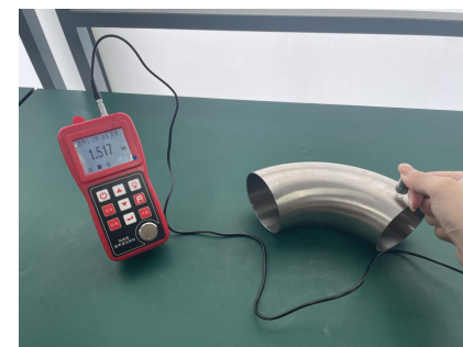
管道厚度——测试实例
