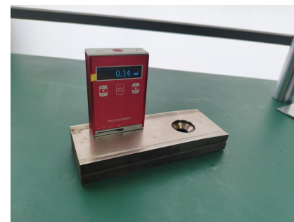
钢板表面粗糙度——测试实例
