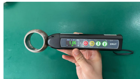
铁圈厚度——测试实例
