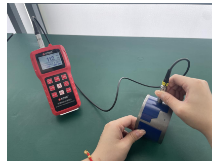
铁上漆层厚度——测试实例
