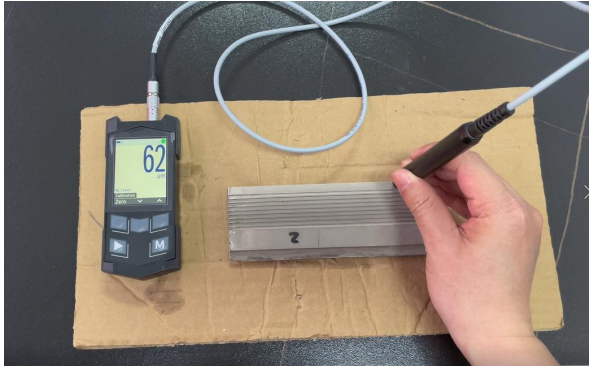
样件表面镀镍层厚度检测——K6-C+PH1
