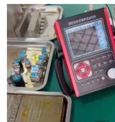
铜板对接焊缝——探伤实例
