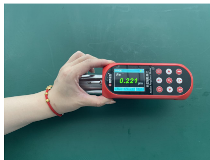
铝管表面粗糙度——测试实例
