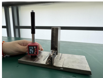
铁板硬度——测试实例
