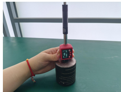
铁棒硬度——测试实例
