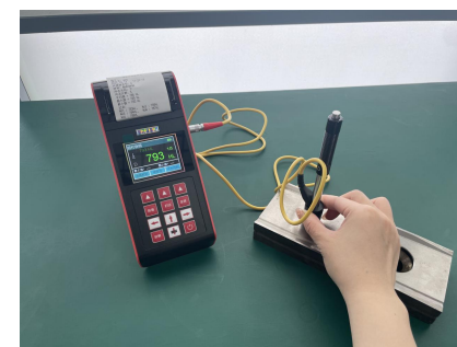
钢板硬度——测试实例
