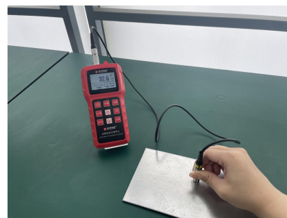
铁上塑粉厚度——测试实例
