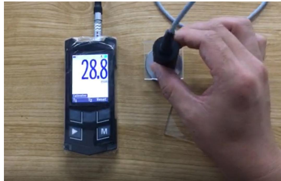
两点校准检测——K6-C+NF3
