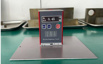
铁板表面粗糙度——测试实例
