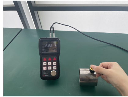
管道厚度——测试实例
