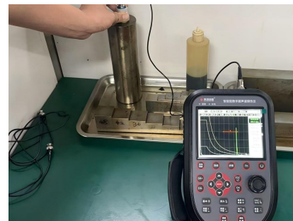
棒材内部缺陷——探伤实例
