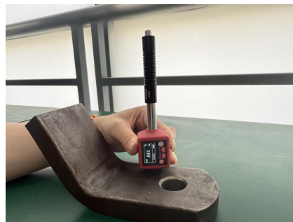
铸钢件硬度——测试实例
