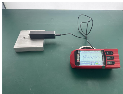
铝板表面粗糙度——测试实例
