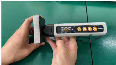
铁板厚度——测试实例
