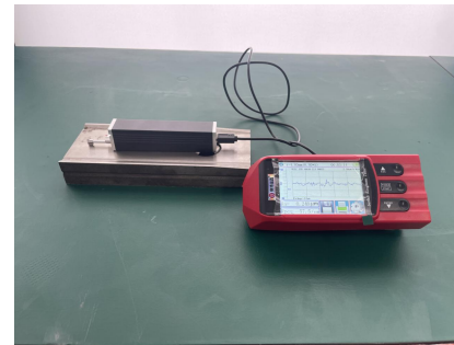
钢板表面粗糙度——测试实例
