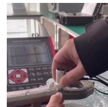
压铸件——探伤实例
