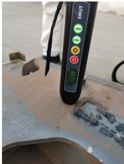
铁板厚度——测试实例
