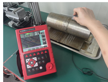
管道焊缝——探伤实例
