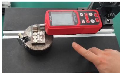
小孔探头异形件——测试实例
