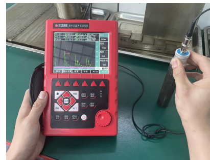
棒材内部缺陷——探伤实例
