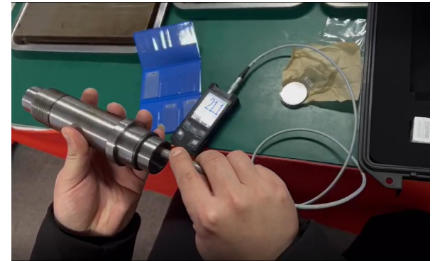
管状工件镀层厚度检测——K6-C+F0-90
