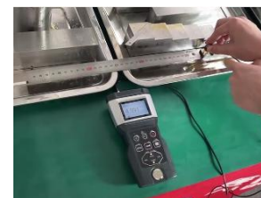
刀片（超薄片）厚度——测试实例
