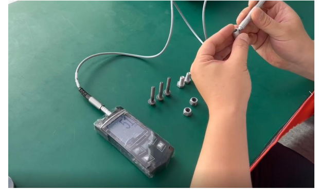
紧固件镀层厚度检测——K6-C+F0
