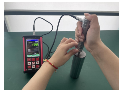
棒材硬度——测试实例
