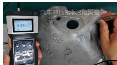
冲压件R角厚度——测试实例
