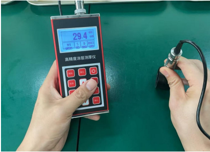
阳极氧化工件——测试实例
