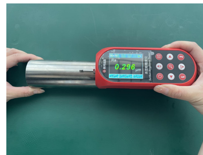
铁管表面粗糙度——测试实例
