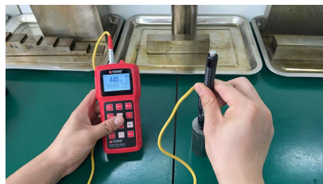
棒材硬度——测试实例
