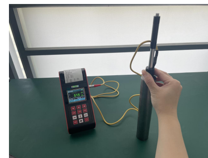
棒材硬度——测试实例
