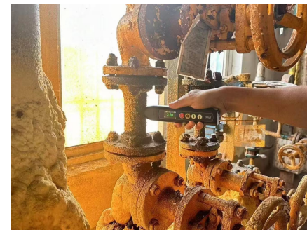
铁管厚度——测试实例
