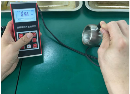
铁圈厚度——测试实例
