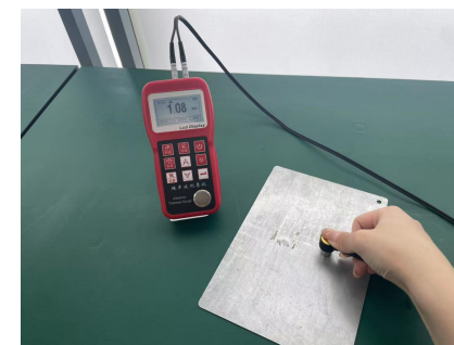
铁板厚度——测试实例
