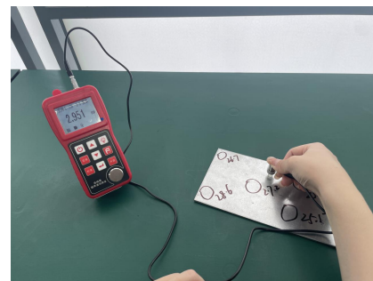
铁板厚度——测试实例
