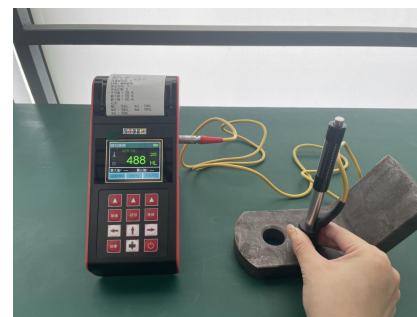
铸钢件硬度——测试实例
