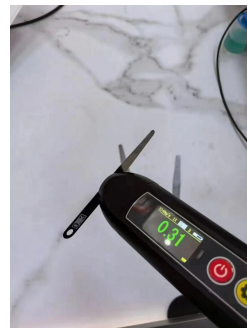
铁片厚度——测试实例
