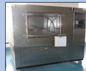
淋雨测试 Rain Test
