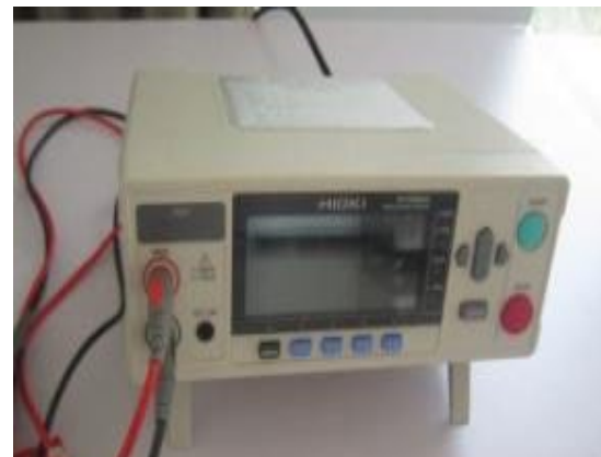
接点防水测试仪量程： 2/20/200/2000/4000MΩ
