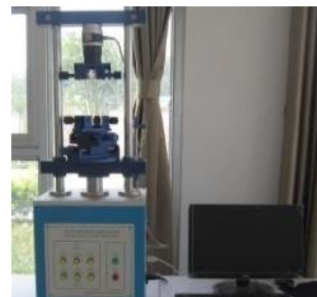
全自动插拔力试验机最大测定高度：150mm
