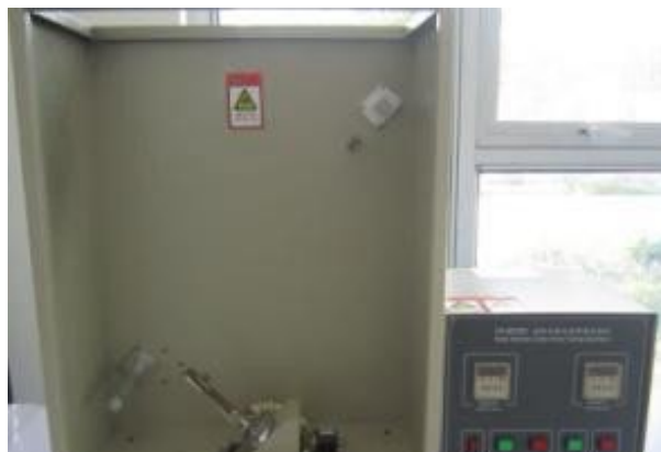
阻燃试验机燃烧气体： 甲烷或煤气
