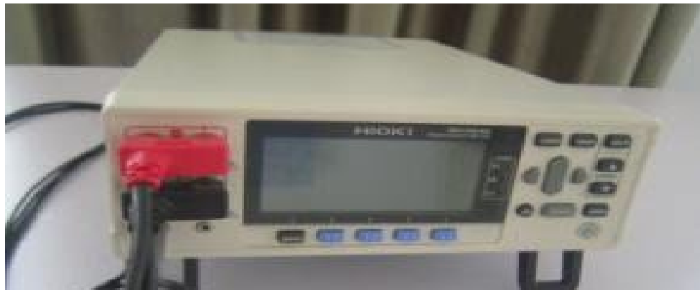
微电阻测试仪量程： 10mΩ~100MΩ
