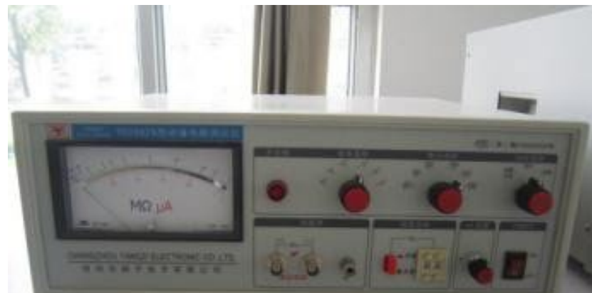
绝缘耐压测试仪测试电压DC： 25~1000V
